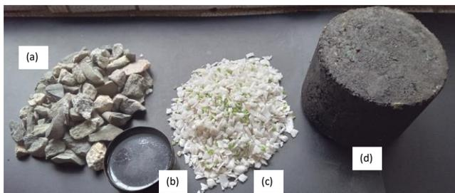
**Figura 4.** Briqueta asfáltica (d) y materiales que la conforman, (a) agregado pétreo, (b) cemento asfáltico y (c) polipropileno reciclado.
