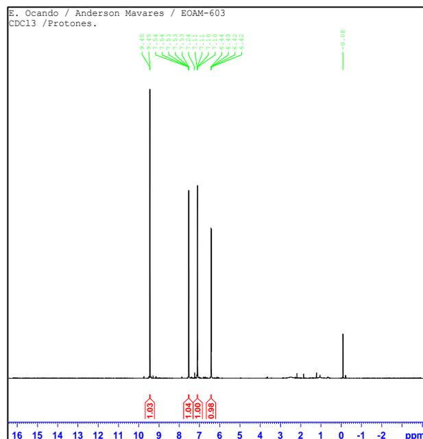
**Figura 8 Espectro del producto obtenido del ensayo 6 (seis días en reposo a una concentración de 30% de H<sub>2</sub>SO<sub>4</sub>) para la síntesis de furfural a partir de cascarilla de arroz**
