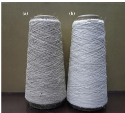
Figura 1. Hilo de PALF. (a) Desgomado, (b) blanqueado Fuente: Pandit et al et al (2020)
