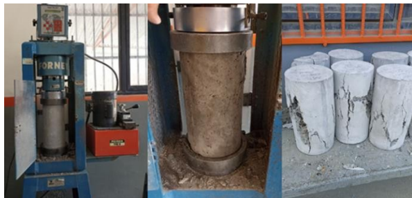
Figura 5: Ensayo a compresión de las probetas cilíndricas.
