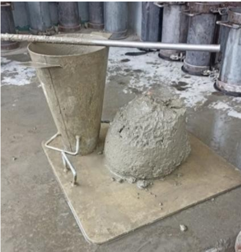
Figura 4: Medición del asentamiento con el Cono de Abrams.
