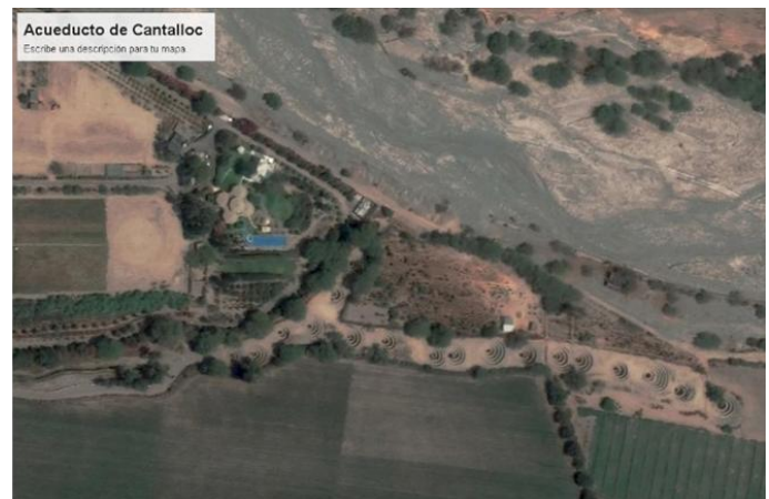
Figura 11. Vista de la captación en el acueducto de Cantalloc. Se destacan los puquios orientados oblicuos y perpendiculares al cauce. Imagen tomada de Google Earth.
