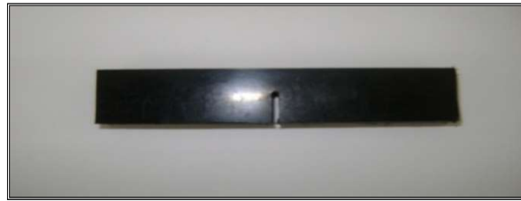
Figura 4: Probeta Tipo SENB extraída de las tuberías de PEAD.
