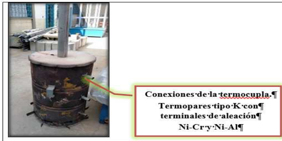
Figura 2: Conexiones de la termocupla en el quemador
