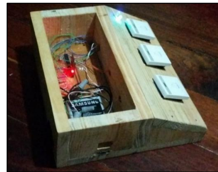
Figura 4: Prototipo definitivo del pedal inalámbrico. Fuente: Elaboración propia
