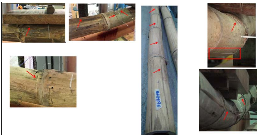
Figura 18: Fallas paralelas a las fibras durante los ensayos a flexión (su ubicación en las probetas se indica con flechas)
