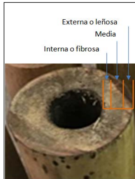
Figura 3: Sección transversal de una probeta de Guadua Angustifolia Kunth. Fuente: Elaboración propia
