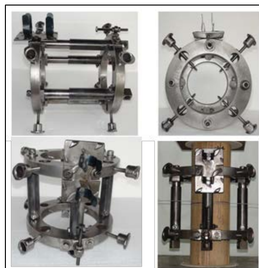
Figura 4: Equipo para medición de deformaciones axiales definitivo, vista lateral, vista en planta y perfil
