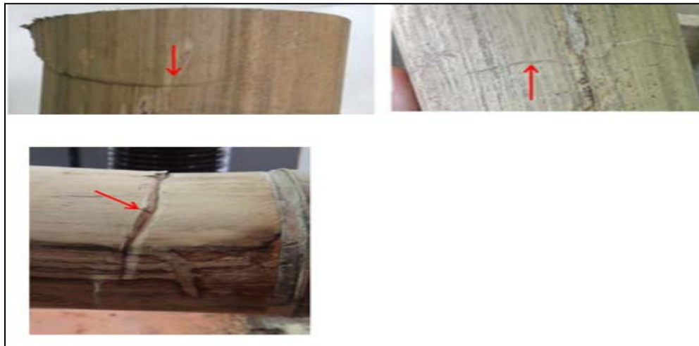
Figura 16: Falla por aplastamiento (fotos izquierda arriba y abajo), falla por tensión de las fibras externas (arriba a la derecha)
