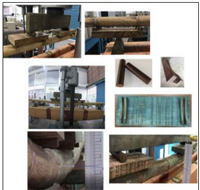
Figura 7: Montaje de los ensayos a flexión en probetas de guadúa con los apoyos diseñados para lograr las cargas
