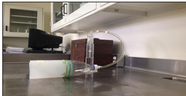
Figura 3: Sistema ensamblado para adsorción de CO 2 emitido por el automóvil. Fuente: Elaboración propia
