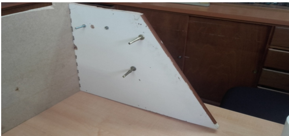
Figura 14: Detalle de la ubicación de los dos elementos de contacto que darán la señal cuando la gaveta superior del balancín alcance su posición máxima y la mínima
