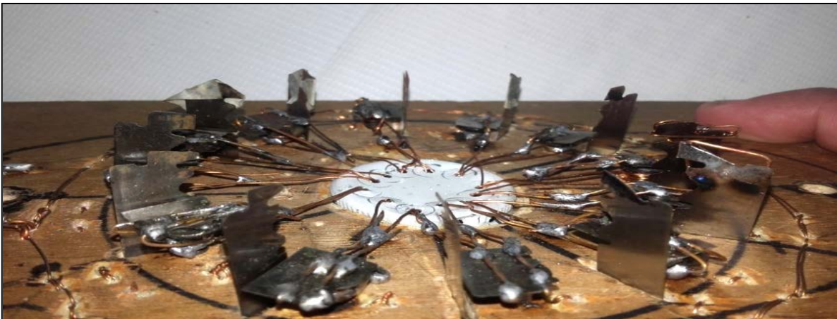
Figura 12: Detalles del montaje del sistema que da la señal en contacto con la aguja del reloj que fue transformado en un temporizador
