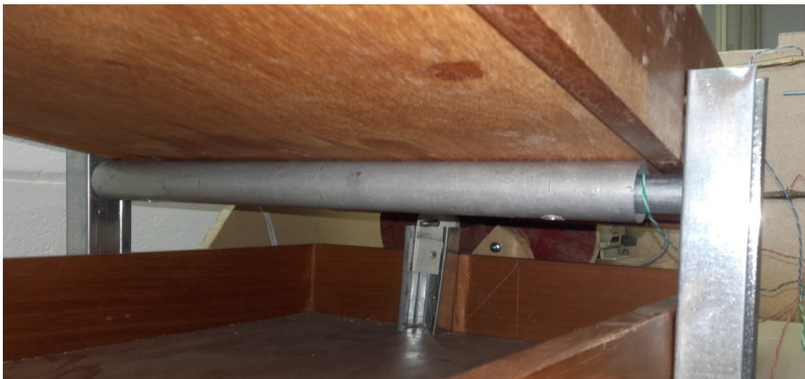
Figura 4: Detalle del montaje de los tubos que permiten el giro de la gaveta superior del balancín. El tubo interno de 46 cm de largo, 2.5 cm de diámetro externo y un espesor de 1 mm se introduce en un segundo tubo de: 40 cm de largo, 4 cm de diámetro externo y un espesor de 2 mm. El tubo externo sujeta la gaveta superior con tornillos
