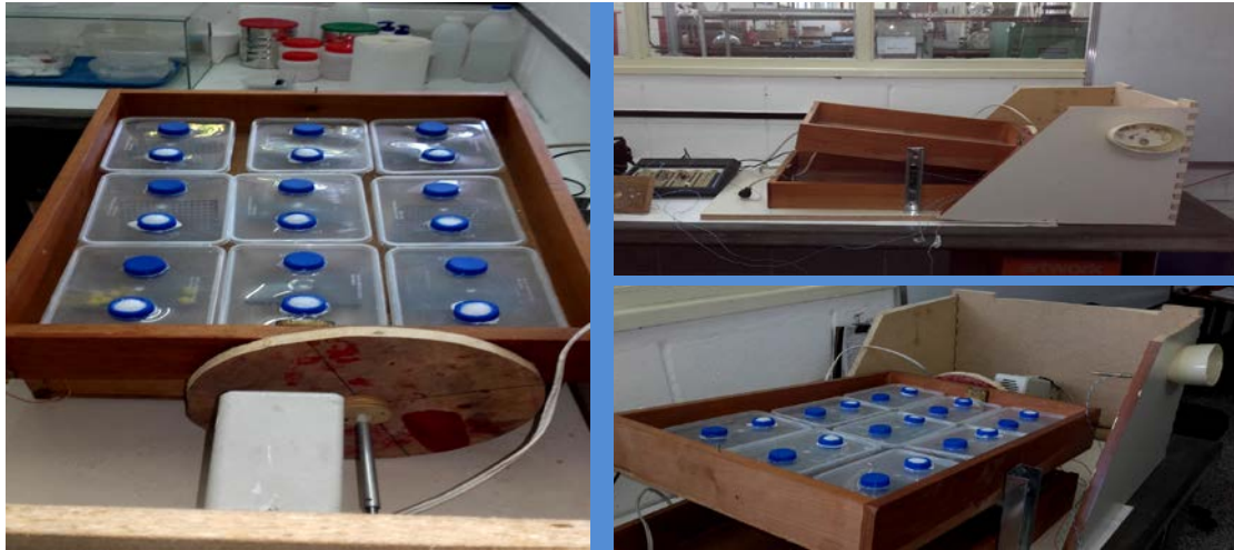
Figura 17: Montaje completo del prototipo del Sistema de Inmersión Temporal de tipo balancín circuito para la propagación in vitro de plantas que se diseñó y construyó como objetivo de este trabajo
