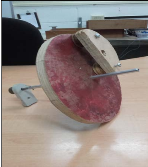
Figura 6: Montaje del disco de madera que transmite el movimiento desde el motor a la gaveta superior del balancín. Observe la posición de la pieza de madera semicircular en posición excéntrica colocada al frente del disco.
