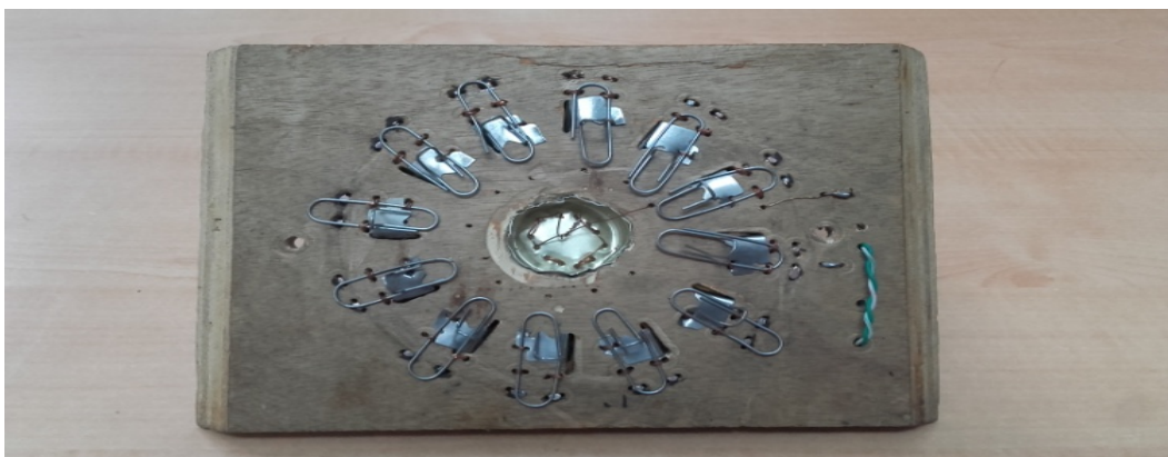
Figura 11: Cara posterior del mismo dispositivo temporizador que se detalla en la Figura 4 donde se muestran como están fijados los clips
