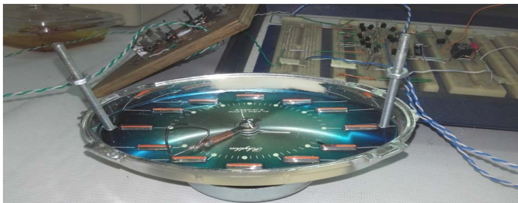
Figura 10: Vista frontal del reloj despertador que se adaptó como temporizador. Los tornillos permiten fijarlo al sistema temporizador. Note el detalle de la aguja del reloj que fue modificada para hacer el contacto con el dispositivo que transmitirá la señal a cada tiempo prefijado
