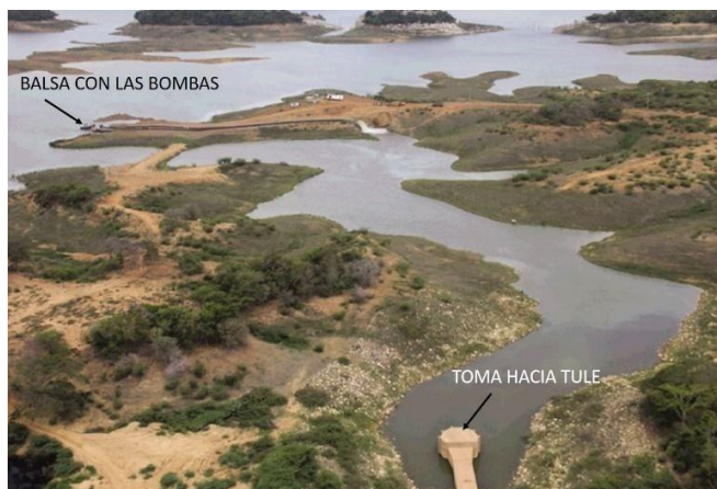
Figura 28. Balsa con las Bombas y Toma Hacia el Embalse Tulé. (Fuente: Internet)
