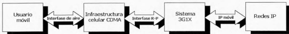
Figura 4. Integración de paquetes de datos y celulares del sistema 3G1x (tomado de: Wireless 3G System. 3Com Corporation)
