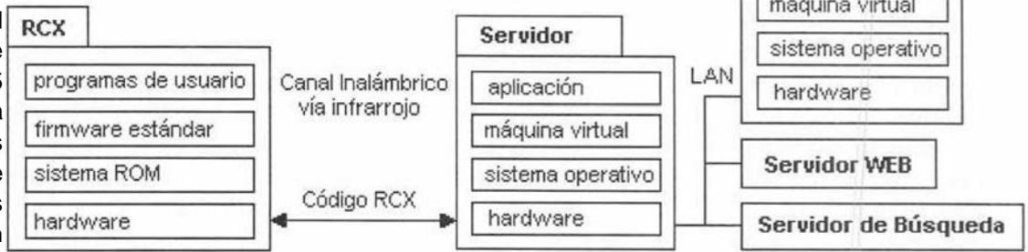
Figura 17: Arquitectura para la manipulación remota del robot
