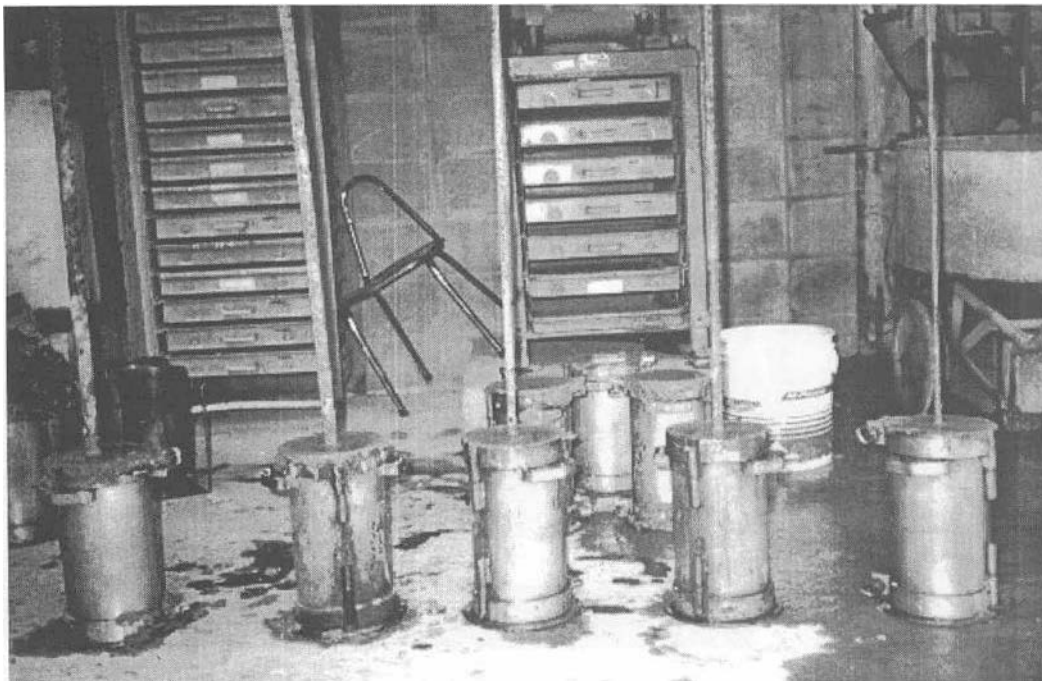
Serie de Cilindros vaciados. Tienen en su interior las cabillas y el refuerzo transversal
