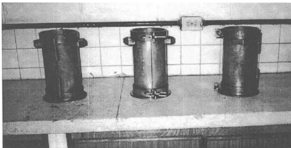
Formaletas para vaciar la mezcla de Concreto
