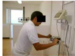
Figura 4: postura típica en una prueba de halar a la altura del hombro
